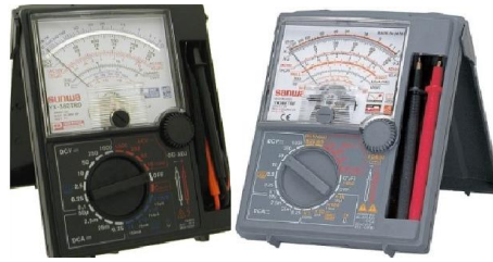
รูปที่ 1.26 มัลติมิเตอร์แบบเข็ม
